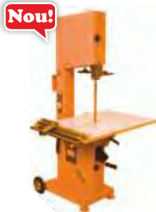
Mașină de tăiat BCA TSC470 COD: BT1009423 230V – 1,85 kW H max. tăiere 47 cm Masă reglabilă 0-90° Greutate: 185 kg
